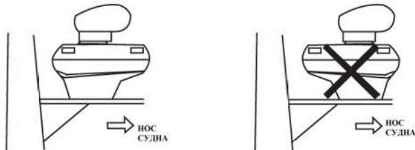
Рисунок 3. Ориентация антенного блока радарной антенны МИРАН «АМ-12»
